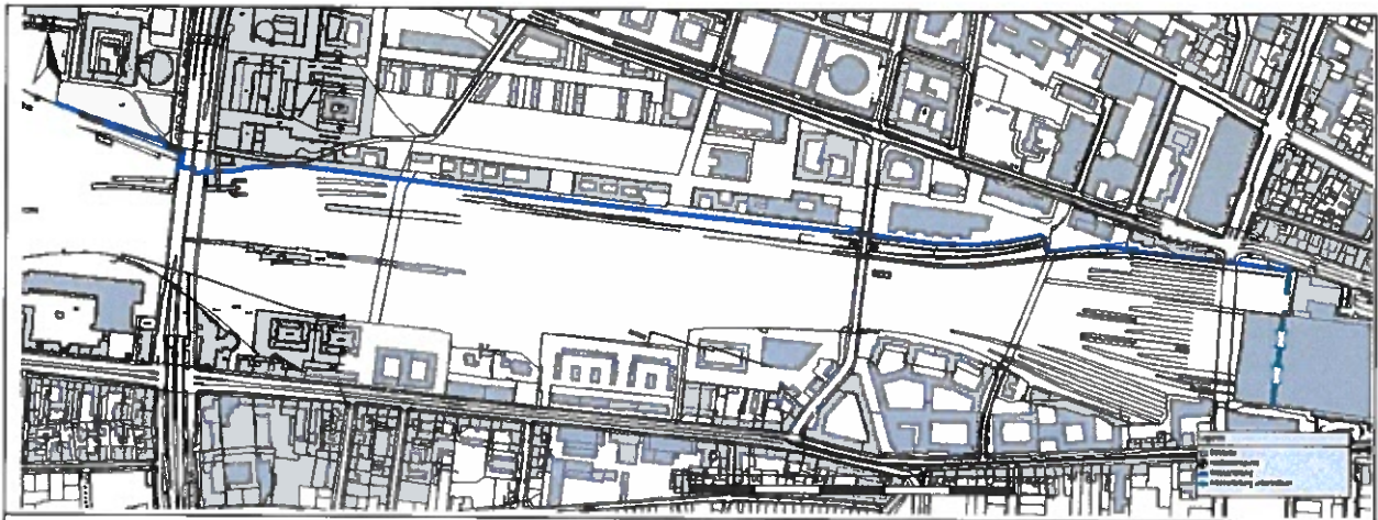
Abbildung 2: Lageplan der Wasserleitungen zwischen Hauptbahnhof und Richelpark
